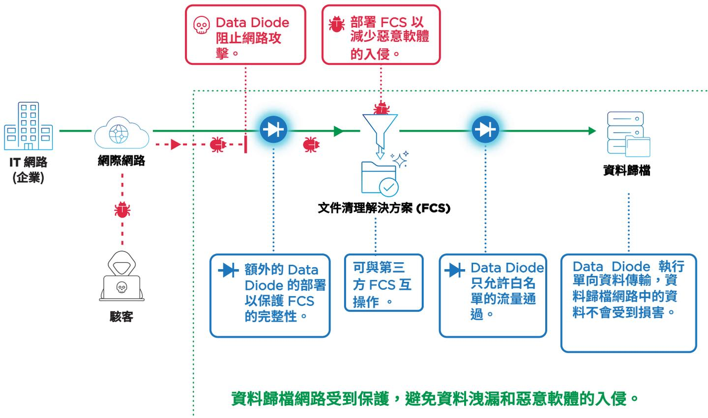
ST Engineering Data Diode 讓文件單向傳輸到資料歸檔網路，同時預防資料洩漏和竊取。
