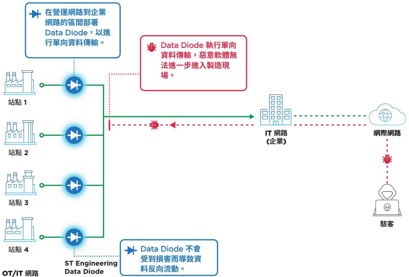
ST Engineering Data Diode 透過單向文檔傳輸或 OT 資料複製，實現對機場、運輸及公用事業運營系統的即時、非侵入式監控，同時預防對關鍵營運系統進行的網路攻擊。
